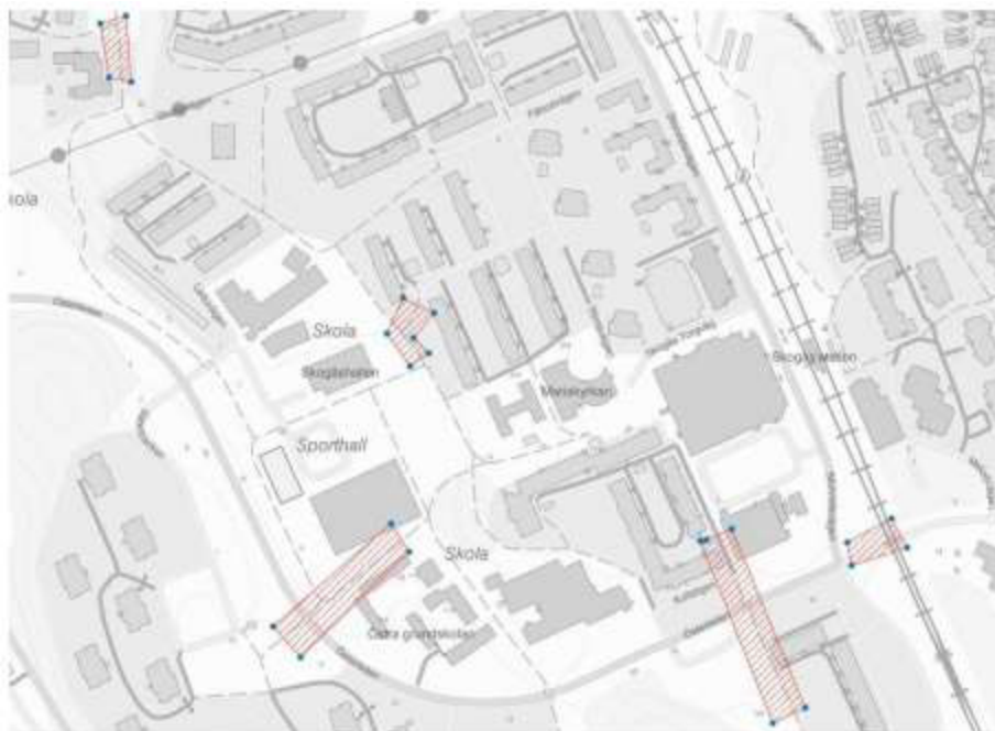
Figur 1. Problemområden för dagvattensystemet i nuläge i västra Skogås. Röd skraffering visar områden med teoretisk kapacitetsbrist.
